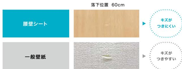
試験方法 5.5mm厚のペニヤに仕上材を両面テープで貼り付け試験体とします。角度60°に取り付けた試験体に、200gの重りをつけた先端のとがった鉄板を高さを変えて落下させ、キズのつき具合を確認します。
